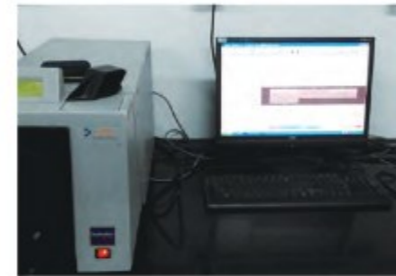
Auto Spectrometer 染色车间自动测色系统 色染めライン自動色測定システム
