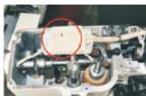
全新的油路设计, 减少关键零件的磨损。
